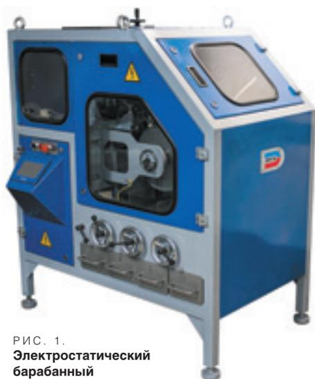
РИС. 1. Электростатический барабанный сепаратор
