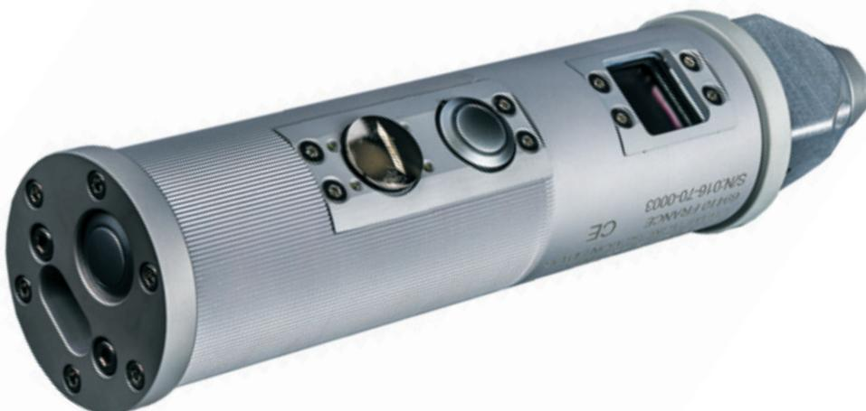
Основная задача прибора — своевременное измерение толщины покрытия непосредственно после его нанесения по всему профилю стеклоизделия и корректировка настроек системы, не ожидая отжига изделия.
